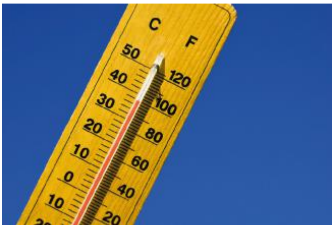
E1.5 Termometro a dilatazione con scale graduate sia in Celsius sia in Fahrenheit.
