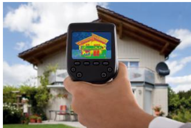
E1.24 Un visore termico inquadra un'abitazione alla ricerca delle dispersioni di calore.
